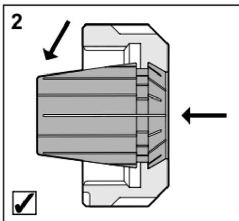
A montagem inadequada pode danificar permanentemente a concentricidade da pinça e irá resultar no desgaste da porca.
